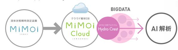
Alを用いた解析では処理の最適化や不要な情報の整理が重要となります。MiMoi SYSTEMでは、独自開発を行った液体分析に特化したアルゴリズムを用いて、液体スペクトルから特徴を抽出します。処理されたデータは元データの約1/1000という非常にコンパクトなデータのため、この特徴を利用することで、今まで実現が難しかった液体のAl解析が可能となり、処理の高速化や精度の向上が図れます。
